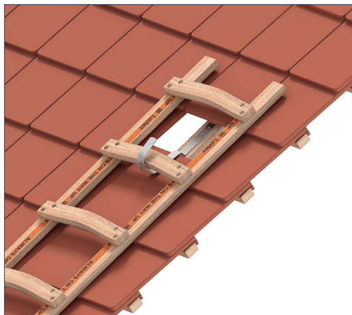
Beispielhafte Anwendung des Sicherheitshakens Modell Z (Pos. 1)
